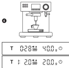
Wenn Sie die Extraktionstaste und die Flüssigkeit tritt in die Tasse eindrücken, taktet der Smart-Modus automatisch und zeigt das Gewicht der Flüssigkeit an. Wenn die Extraktion beendet ist, entfernen Sie den Becher und die Anzeige wechselt ab.: Zeit-/Fluidgewicht-Flüssigkeitsverhältnis/Pulvergewicht (Bewegen Sie die Kaffeewaage während des Extraktionsprozesses bitte nicht)
