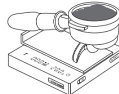
Aufgrund die Version 1.0 der Kaffeewaage keine klare AnzeigederTastenschalter aufwies, wurde die Version 2.0 mit einem schwerkraftabhängigen Schaltmechanismus nachgerüstet
