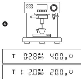
④ 抽出ボタンを押して、液体がカップに流れ込むと、スマートモードが自動的にタイマーを起動し、または液重が表示されます。抽出が終わったら、カップを移動してください。表示画面は次のように交互に表示されます: 時間/液重-液重比/粉重 (抽出中は、コーヒースケールを移動しないでください)
