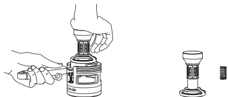
自動高さ調整 (タンピングに適した 最大寸法は13mm)
