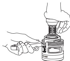
Adaptive Höhe (Tampern bis zu einer maximalen Höhe von etwa 13 mm)
