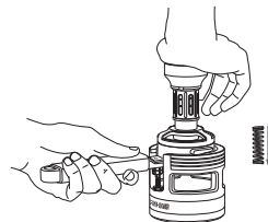
Impakt-Tampern (Wenn ein akustisches Feedback ertönt, ist das Tampern abgeschlossen)
