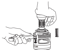
衝擊力填壓 (當有聲音反饋時, 提示填壓已經完成)
