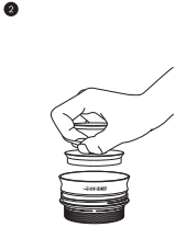
套上磁吸接粉环，加入 18g咖啡粉， 摇晃使咖啡粉均匀分布后，用压粉器直接填压紧实
